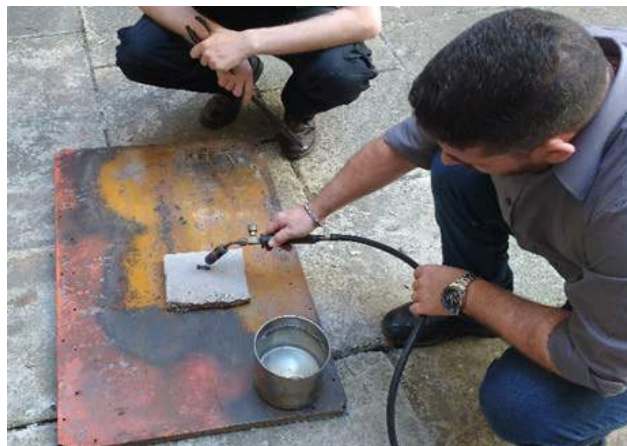
Figura 2. Se realizaron varios eventos de recocido de la placa de cobre cada vez que la tensión acumulada la tornaba quebradiza. Trabajo realizado en las instalaciones del GAM-FIUBA (foto de los autores).
