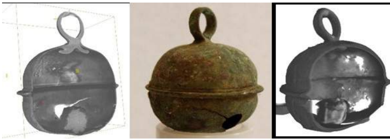
Figura 2: Cascabel en el que se observa el escrupulillo en su interior – De izquierda a derecha: Tomografía de RX, Imagen luz directa, Tomografía de neutrones
