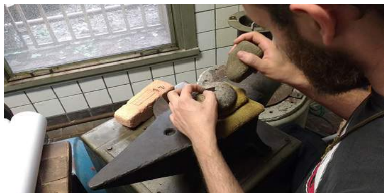
Figura 1. Trabajo de laminación y rectificación en una placa experimental de cobre. Trabajo realizado en las instalaciones del GAM-FIUBA (foto de los autores).
